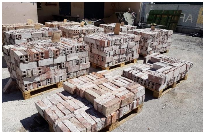
Ombruk av teglsten Ruseløkka skole. Bilde: Undervisningsbygg
