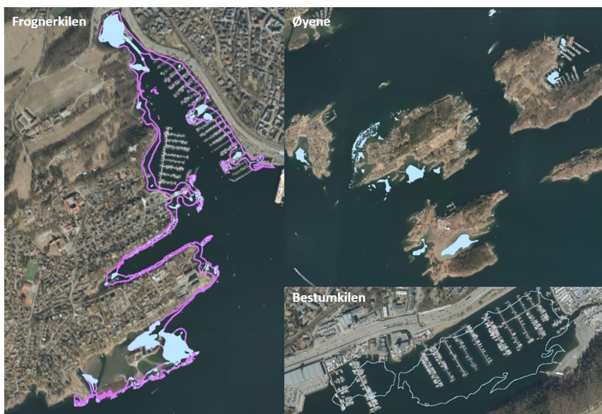
Figur 9. Grunne (1–5 m dyp) og flate områder (skråning < 3 grader) som kan egne seg for restaurering/etablering av ålegras. For Frognerkilen er området delt mellom grunne (lilla omriss) og både grunne og flate områder (blå flate), for Bestumkilen vises grunne og flate områder (blått
